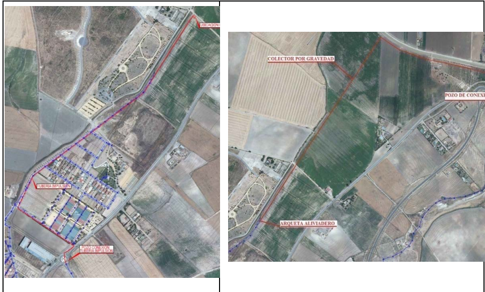
Figure 2: Imagen IZQ Alternativa 1: Ebar, Imagen DER Alternativa 2: Gravedad
