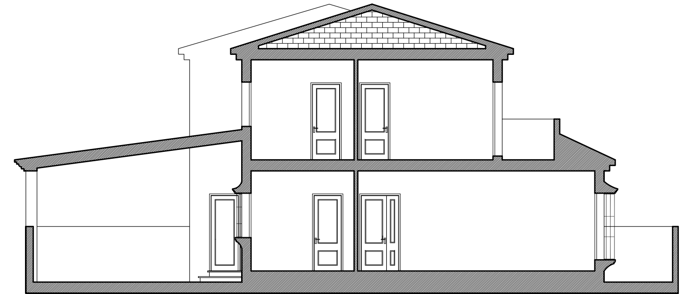
SECCIÓN ACABADO CON CUB. INCLINADA
